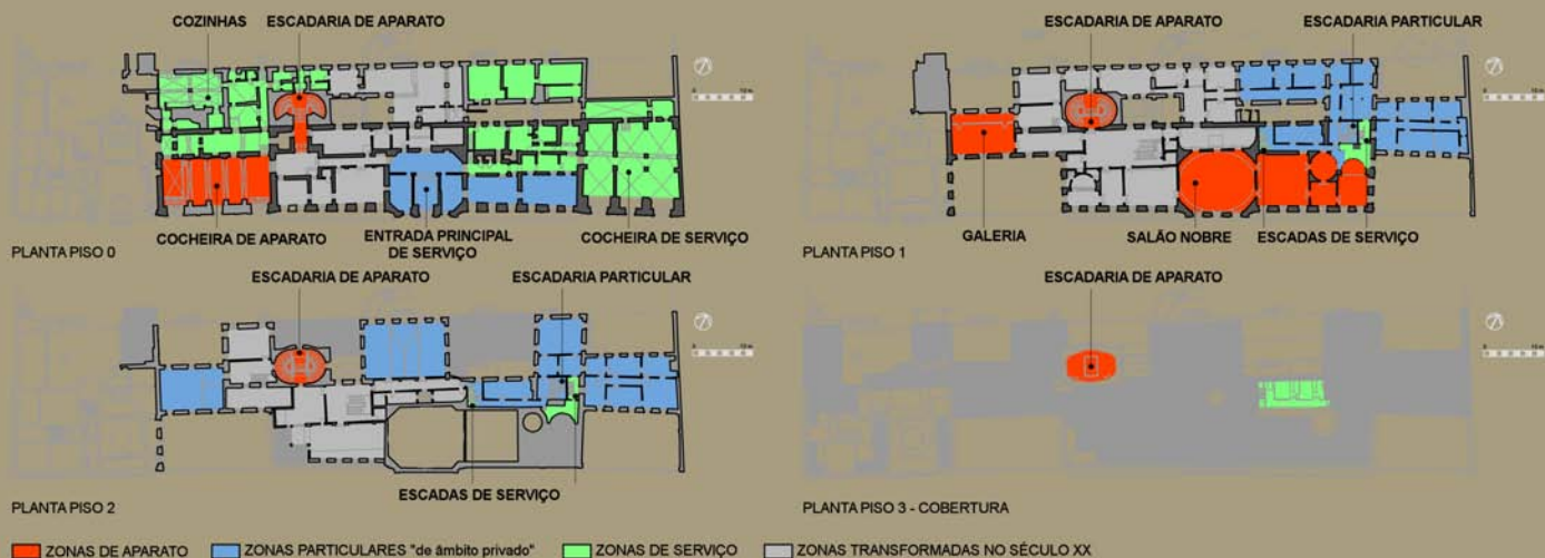
Ilustração 15 Desenho dos pisos do palácio com a identificação conjectural das zonas de aparato, as zonas particulares, as zonas de serviços e o alcance da última intervenção realizada na década de 80 do século XX.
