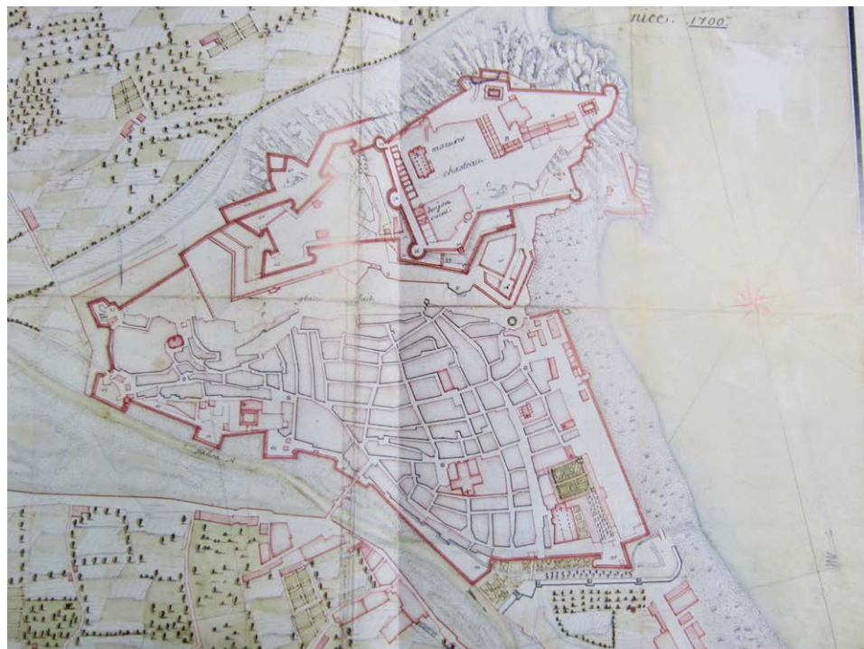
Fig. 3 – Plan de la ville et château de Nice, 1691, Antoine Niquet. Vincenne, Service Historique de l'Armée – Cartes et plans J10 C 1096-2. Le canal des moulins, en trait bleu, longe l'enceinte en retrait des bastions marqués en rouge, puis les traverse pour se poursuivre dans les jardins situés au-devant.
