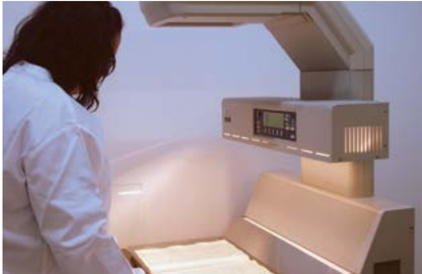
Fig. 4 – Digitalizadora vertical, com o sistema de compensação de lombada, um dos meios usados no Arquivo Municipal de Penafiel para digitalização dos fundos.
