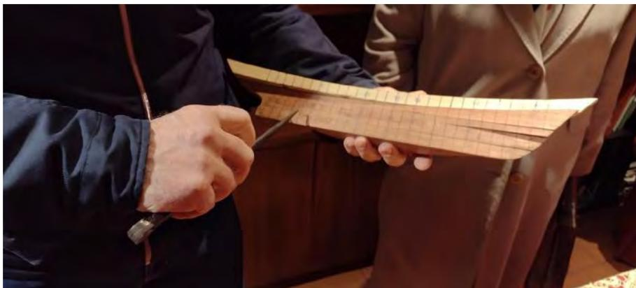
Figura 11 – Meio casco com escantilhões. António José Carmo, mestre desenhador naval, Estaleiro Naval Samuel & Filhos (Azurara), no projeto “Técnicas Tradicionais usadas na Sala do Risco”. Museu da Alfandega Régia e da Construção Naval de Vila do Conde, dezembro 2021.
