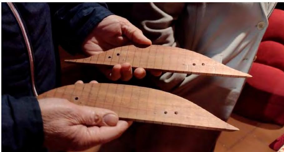
Figura 12 – Meio casco com escantilhões. António José Carmo, mestre desenhador naval, Estaleiro Naval Samuel & Filhos (Azurara), no projeto “Técnicas Tradicionais usadas na Sala do Risco”. Museu da Alfandega Régia e da Construção Naval de Vila do Conde, dezembro 2021.
