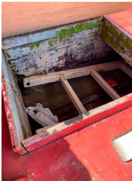
Figura 10 – Escotilha, através da qual se atinge o porão
