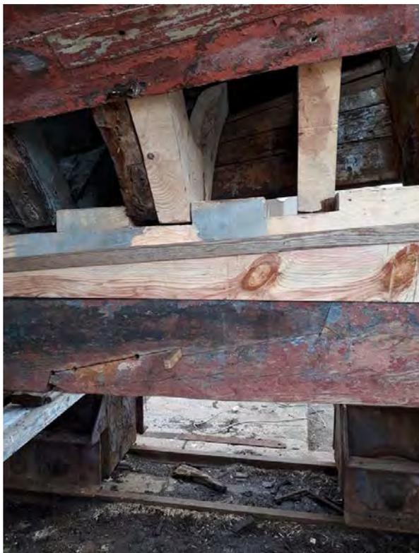
Figura 13 – Escarva à navio ou de *ganzepe* na quilha para o cadaste. Colocação do primeiro “tarugo”, um tacho de madeira rectangular e fino, que se martelava para entrar no orifício que ajustava as duas peças de madeira milimetricamente e que junto com as cavilhas (tacos de madeira redondos e mais pequenos que o tarugo) selavam o conjunto. Galeão do Sal “Riquitum”, Setúbal, maio de 2020. Arquivo Associação Portuguesa do Património Marítimo.
